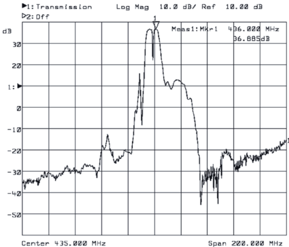
Figure 15 : Mesure du préamplificateur réponse en fréquence sur 200 MHz d'étendue.
