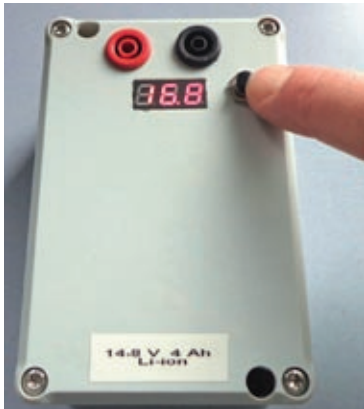
Figure 1 : La batterie terminée et contrôlée par simple appui sur le bouton poussoir du voltmètre.
