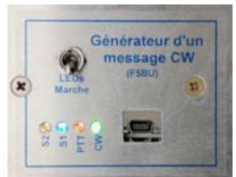
Figure 7. Le panneau avant réalisé avec mon programme Galva
