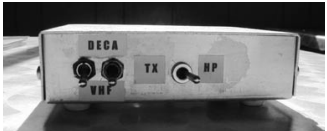
Face avant du boîtier de commutation
