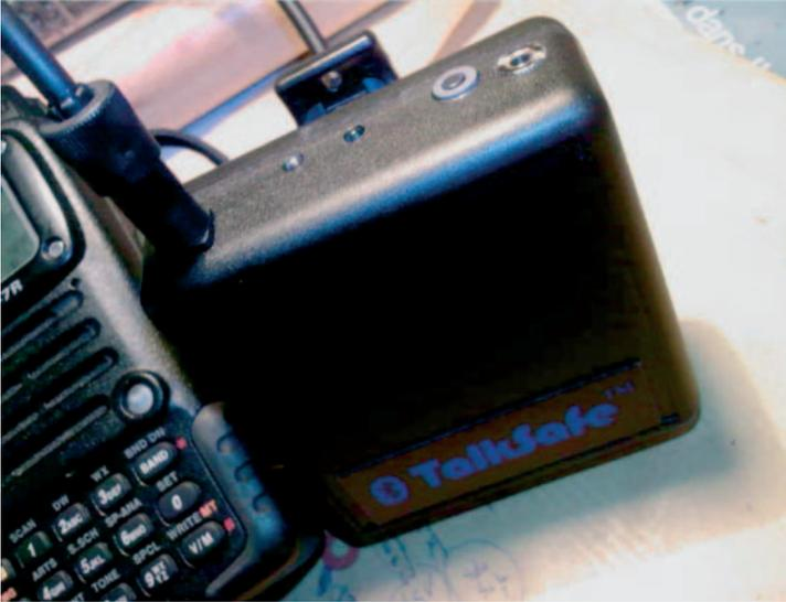
Le Talksafe Ranger est une petite boîte noire qui permet d'utiliser une oreillette bluetooth sur un transceiver. Cet appareil s'attache à la ceinture à l'aide d'une pince et se connecte sur un TRX portatif (mobile ou fixe) via un câble compatible (préciser le ou les transceivers utilisé(s) à l'achat, à votre revendeur).
