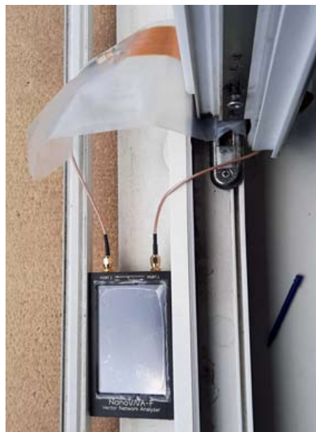
Fig.6 - Mesure du circuit Flex traversant une fenêtre
