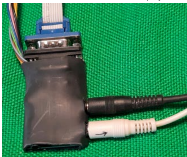
Fig.2 - L'interface terminée et protégée par de la gaine thermorétractable
